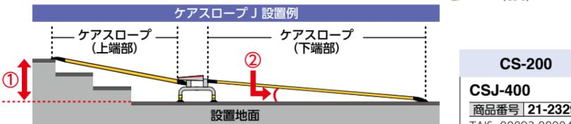
ジョイント台とケアスロープ(下端部)の設置地面がフラットである場合、下端部に設置するスロープの長さが長いほど、②の傾斜角度が緩やかになります。
