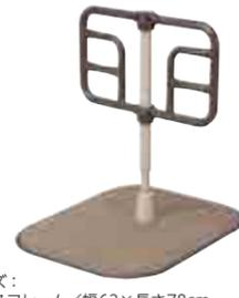
サイズ: ベースフレーム/幅63×長さ78cm 手すり部/幅60×高さ70~85cm (3cm間隔6段階高さ調整) 重量: 21.5kg 材質: ベース・手すり/スチール ベースゴム/合成ゴム 回転リング/ポリアセチル樹脂、アルミニウム 支柱カバー/ポリプロピレン カーペット/表面ポリエステル、裏面アクリル樹脂
